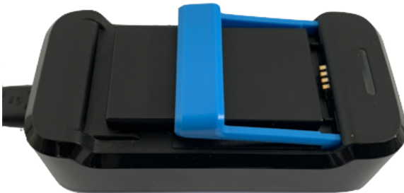
Afbeelding 5: onjuist geplaatste accu
